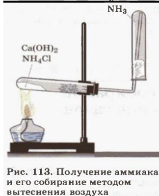
Рис. 113. Получение аммиака и его сбор методом вытеснения воздуха
