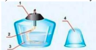
Спиртовка (см. рисунок) состоит из сосуда (резервуара) (3), в который налит спирт, фитиля (2), укрепленного в металлической трубке с диском (1), и колпачка (4).
